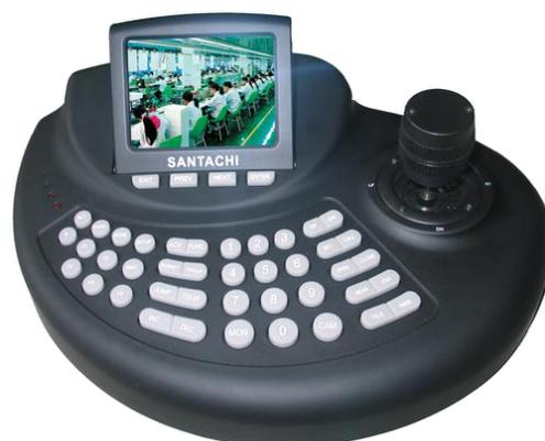
该网络键盘集成视频解码器，可独立作为一个客户端使用，它可以把任意视频显示在自带的 LCD 显示屏上。并可以控制电视墙，把任意视频显示在相应的监视器上。
